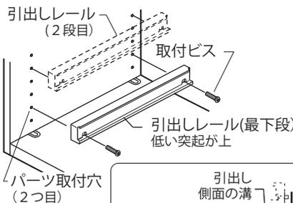
※ 2段目以降は2穴飛ばし (150 mm間隔) で3つ目の穴にレールを取り付ける。
