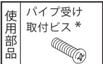
お好みの高さのパーツ取付穴にパイプ受けを取り付け、パイプ受けの上方からパイプを下方に下ろし、溝にパイプをはめ込みます。
